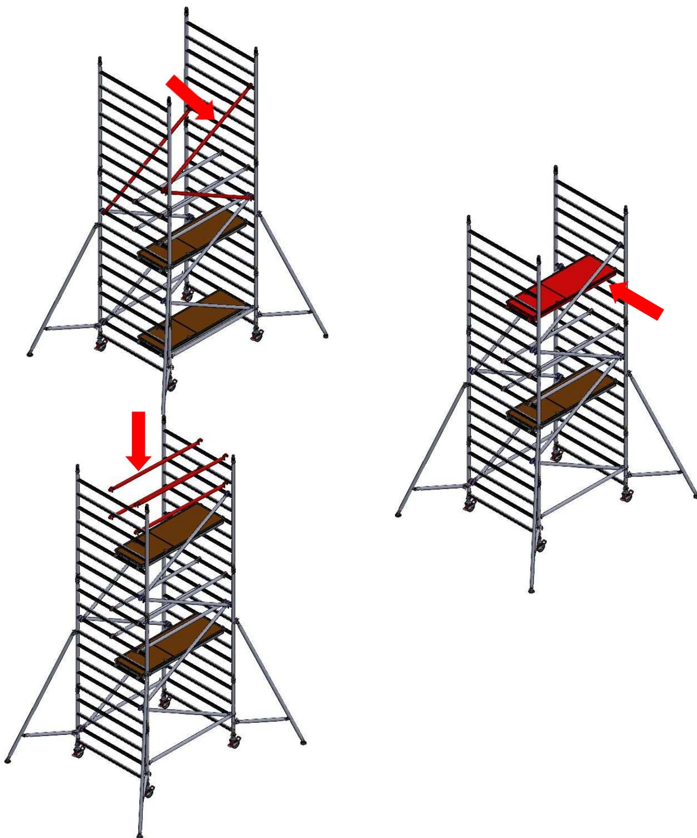
8. Nasaďte poslední úhlopříčné vzpěry podle obrázku níže. Tento krok zajistí ukončení ve výšce podlahy 4m. Připoje úhlopříčné vzpěry dle kroku č. 7, průlezová podlážka by se měla posunout nahoru na osmou příčku, vedle této podlážky lze nyní namontovat pevnou podlážku. Vylezte nahoru přes průlezovou podlážku a namontujte vodorovné zábradlí/vzpěry, a to na devátou a desátou příčku na obou stranách věže. Montáž věže dokončete podle obrázku č. 9.
