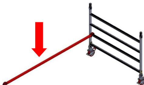
3. Namontujte rám podle obrázku vpravo. Připojte konec vodorovné vzpěry k druhému konci rámu. Nyní spojte rami pomocí druhé vodorovné vzpěry na opačné straně. Vzpěry zajistěte, tímto by měla být věž rovná, její rovinu zkontrolujte pomocí vodováhy.
